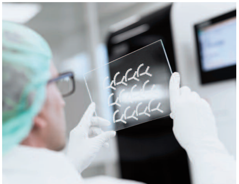
Glasplatte als Trägermaterial beim Freeformen für resorbierbare C- und Y-Platten
