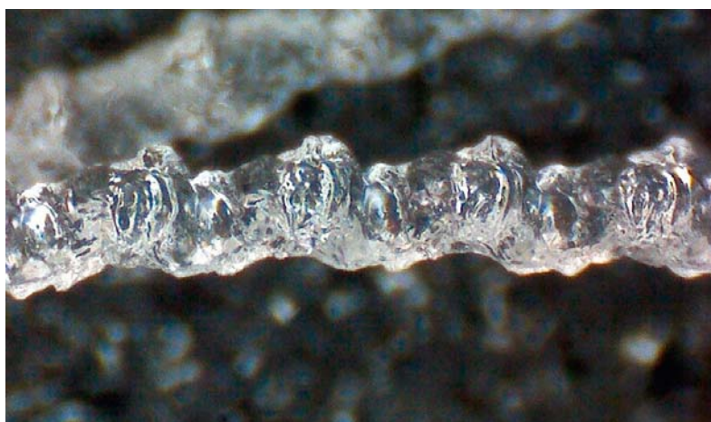
Perlenkette, Faden bei Austragsmittlung von Resomer LR 704 S unter dem Mikroskop
