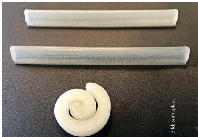
1K-PCU-Stab 55 D und umhüllte 2K-PCU-Spriele – hergestellt im additiven Verfahren
